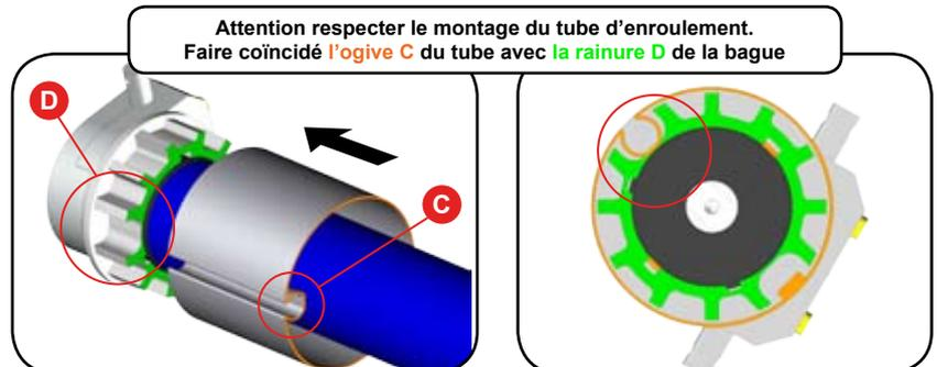
Attention respecter le montage du tube d'enroulement. Faire coïncider l'ogive C du tube avec la rainure D de la bague
