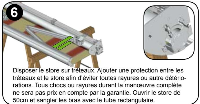
Disposer le store sur tréteaux. Ajouter une protection entre les tréteaux et le store afin d'éviter toutes rayures ou autre détériorations. Tous chocs ou rayures durant la manœuvre complète ne sera pas pris en compte par la garantie. Ouvrir le store de 50cm et sangler les bras avec le tube rectangulaire.
