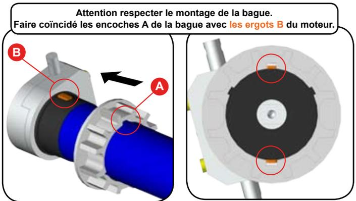
Attention respecter le montage de la bague. Faire coïncider les encoches A de la bague avec les ergots B du moteur.
