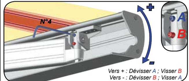
Attention : Un mauvais réglage de la barre de charge peut entraîner une mauvaise fermeture de votre store.
