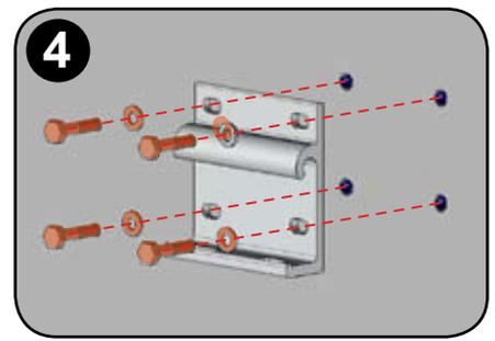
Fixation avec des vis Ø10mm. Kit de vis, cheville et rondelle non fournis.
