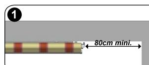
Dans le cas d'une pose entre mur, vérifier la distance entre le store (côté manœuvre) et le mur. Dans le cas où cette distance serait supérieure à 80cm il vous est possible de changer le monteur sans démonter le store de ces supports. Dans le cas contraire démonter le store des supports, et respecter les opérations 1 à 10 du changement de toile et changer le moteur.
