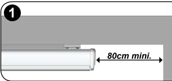
Dans le cas d'une pose entre mur, vérifier la distance entre le store (côté manœuvre) et le mur. Dans le cas où cette distance serait supérieure à 80cm il vous est possible de changer le moteur sans démonter le store de ces supports. Dans le cas contraire démonter le store des supports, et respecter les opérations 1 à 10 du changement de toile et changer le moteur.
