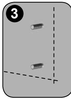
Pour la fixation du store, utiliser des tiges filetées de Ø 10 mm (non fournies). Sceller les tiges filetées, elles doivent sortir de 30 mm pour la fixation du store. Se référer à la notice du fournisseur pour la pose du scellement chimique.
